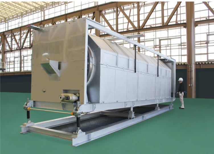
焙煎機 業界：食品 寸法：2.1m×2.7m×8m 材質：SUS304・SS400 重量：7t
