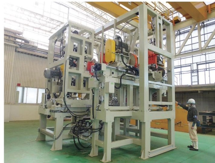
木材加工機 業界：農林 寸法：6m×6m×2m 材質：SS400・S45C 重量：10t
